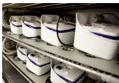
Chaque caméra est testée à des températures extrêmes avant sa distribution.
