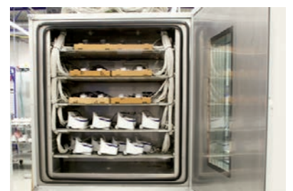
Chaque caméra est testée à des températures extrêmes avant sa distribution.
